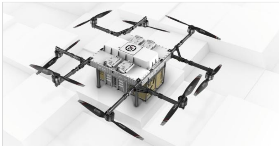
教学真机： 载重/航程：30kg/10km，尺寸：236*236*46cm。
